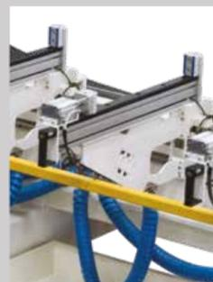
Posizionamento sequenziale o simultaneo delle morse
